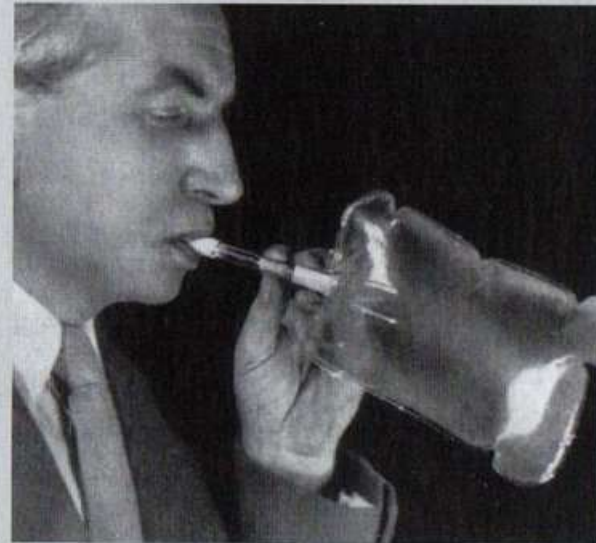
Exempel på första generationens instrument för alkoholutandningsprov för sållningsbruk: Alcotestampull och ballong
