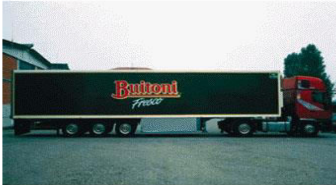
Vista diurna di un autocarro al quale è stata applicata la bordatura retroriflettente
